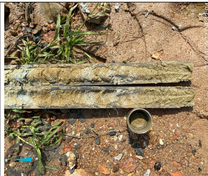
Lớp 2: Cát bụi màu nâu vàng, xám trắng, trạng thái bão hòa nước, kết cấu chặt vừa đến chặt
