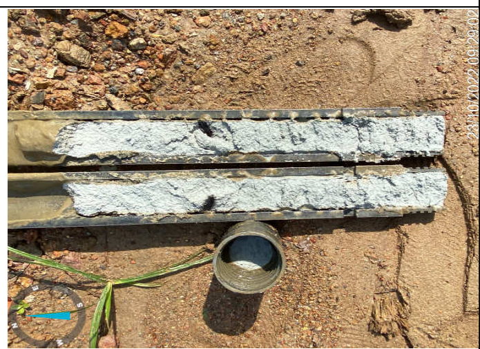
Lớp 1C: Cát mịn màu xám trắng, trạng thái bão hòa nước, kết cấu rời
